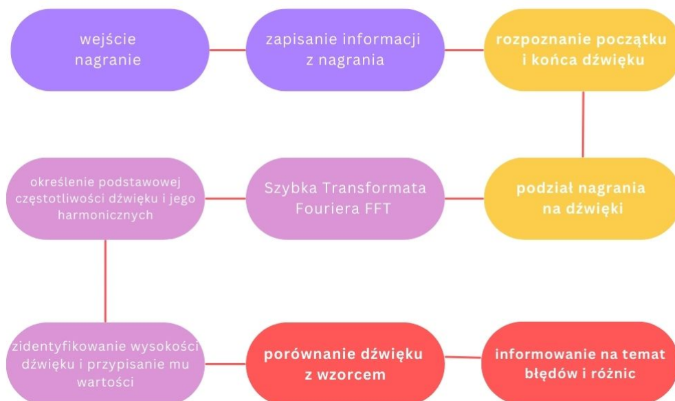
Rysunek 4.1 Schemat struktury systemu do analizy zapisanych utworów
