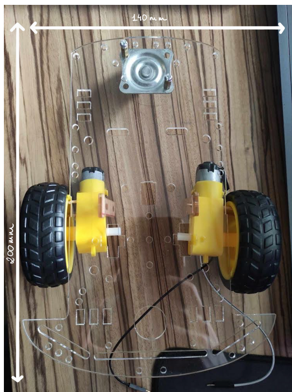
Rysunek 3.2 Korpus robota z układem napędowym
