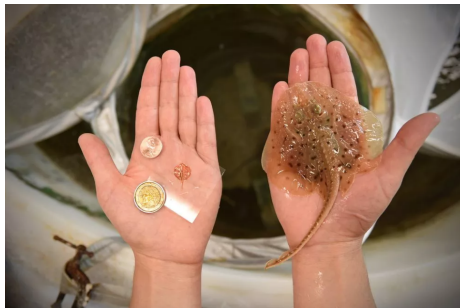
Rysunek 3.2: Robotyczna płaszczka z hydrożelu, złota i mięśnia szczura źródło: [19]
