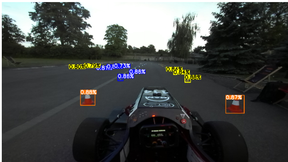
Rysunek 2.3 Obraz z kamery z nałożonymi wykryciami pachółków
