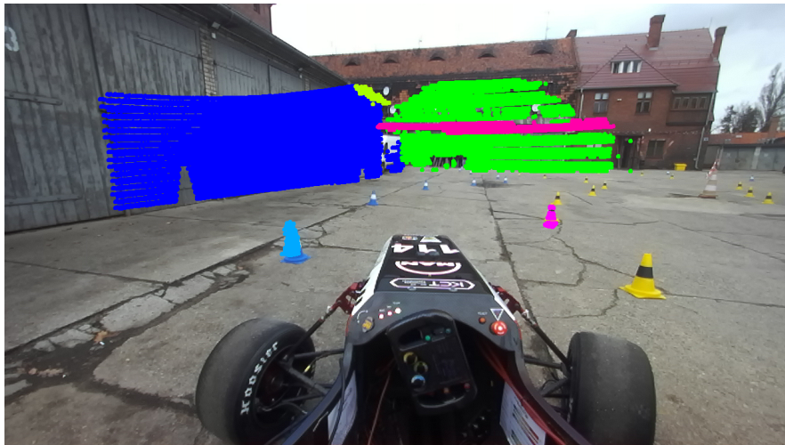
Rysunek 4.4 Projektacja chmury punktów lidar na obraz kamery z segmentacją przed automatyczną kalibracją
