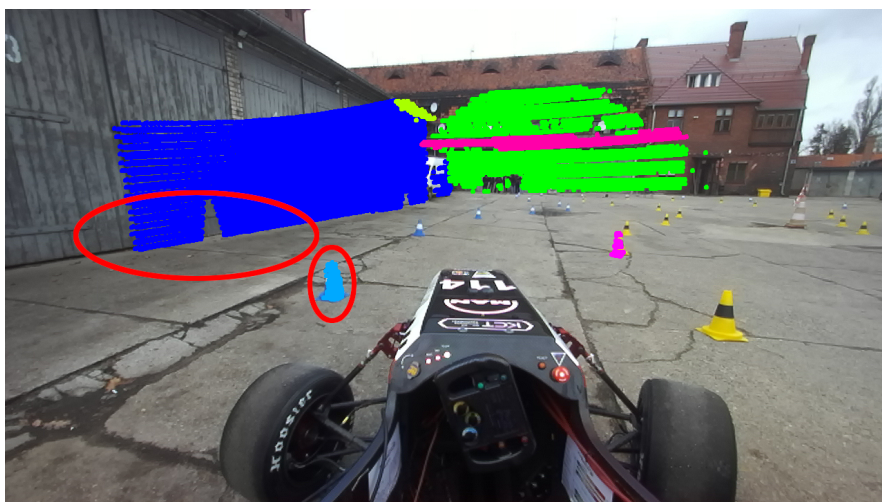
Rysunek 4.5 Projektacja chmury punktów lidar na obraz kamery z segmentacją po automatycznej kalibracji. Czerwonymi elipsami zaznaczono obszary, gdzie różnica przed i po kalibracji jest najbardziej widoczna
