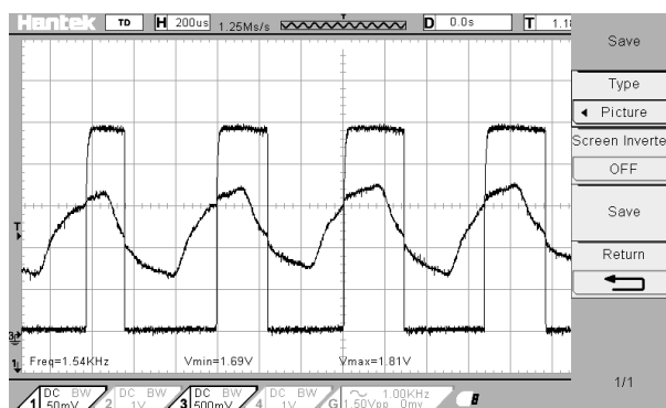
Rysunek 4.11 Oscylogram przebiegu sygnału wejściowego i wyjściowego komparatora
