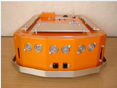
Miniplatforma mobilna z wielosensorycznym systemem detekcji przeszkód
