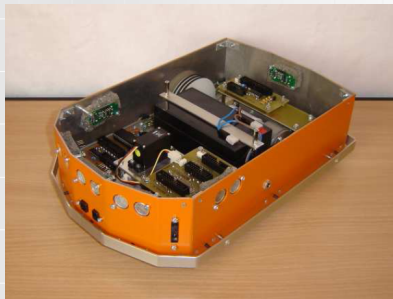
Miniplatforma mobilna z wielosensorycznym systemem detekcji przeszkód
