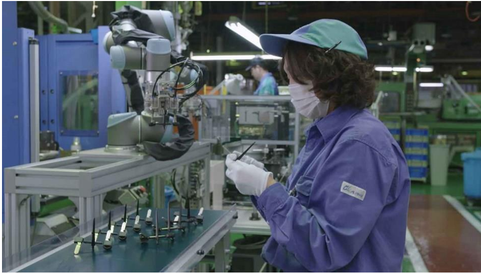
Rysunek 4.1 Robot UR3 w aplikacji dla Alpha Corporation [24]
